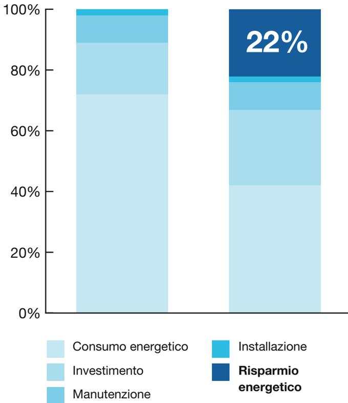
Il consumo di aria all'interno della rete non è costante nel tempo. Un compressore a velocità variabile riduce la velocità del motore in base al consumo di aria compressa. In questo modo, è possibile ottenere un notevole risparmio di energia elettrica.
